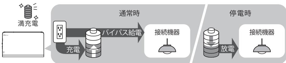
停電復旧時の電力供給は、リチウムイオン電池による放電電力から商用電力に自動的に切り替えます。ただし、漏電の恐れがある場合には、本製品の電源を切り、接続されているケーブル等をすべて抜いてください。商用電力が停電から復旧した時の本製品の動作モードは、バックアップモードになります。
