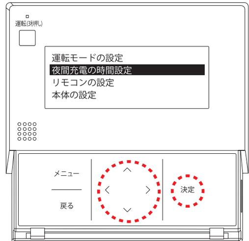
**3** 上下左右ボタンを押して、任意の時間を設定します。初期設定では、以下のように設定されています。
