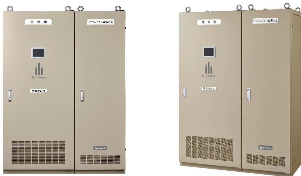
本製品は無瞬断 UPS を搭載しているため、停電時も瞬断時間がなく、安心して重要負荷のバックアップにお使いいただけます。また単相 100V/200V、三相 200V 対応で、多様な設備への電力供給が可能です。通常時は指定時刻に充放電を行うことで、電力のピークシフトも可能です。
